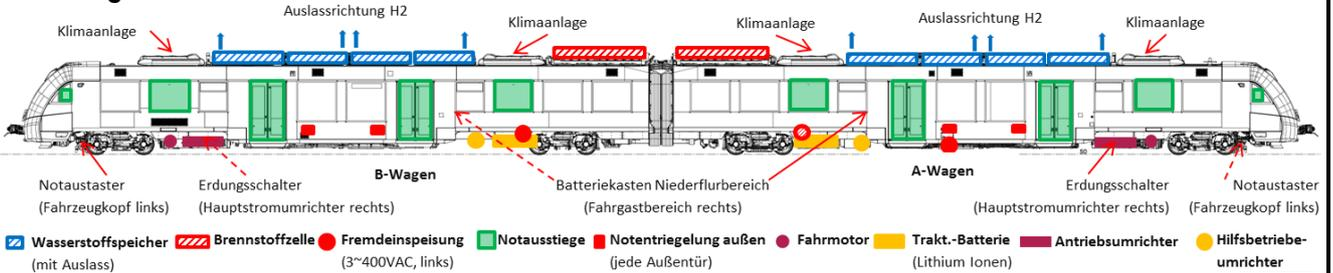
Der CORADIA iLINT 54 ist ein zweiteiliges Brennstoffzellen-Batterie-Hybrid-Fahrzeug. Er verfügt je Wagenkasten über eine Wasserstoffspeicheranlage (350 bar bei 15°C, gasförmig) auf dem Dach und eine Traktionsbatterie (Lithium-Ionen) im Unterflurbereich. Zugang zum Führerstand ist nur über den Fahrgastbereich möglich.
