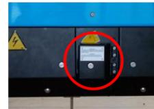
Erdungsschalter (Hauptstromrichter rechts, Deckel geschlossen)
