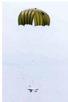
Das unbemannte Luftfahrzeug KZO ist propellergetrieben und wird zu Aufklärungszwecken eingesetzt. Der Start erfolgt aus einem Startcontainer mit Hilfe eines Feststoff-Raktentriebwerkes (Booster). Die Landung erfolgt ausschließlich an einem Fallschirm.
