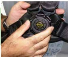
Die Crew ist mit einem Fünf-Punkt-Sicherheitsgurt-System ausgestattet. Zum Öffnen den Drehgriff am Zentralschloss um 90° drehen
