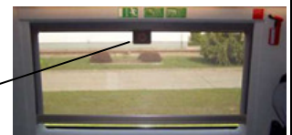
Notausstiegsfenster als Einschlagfenster mit rotem Punkt
