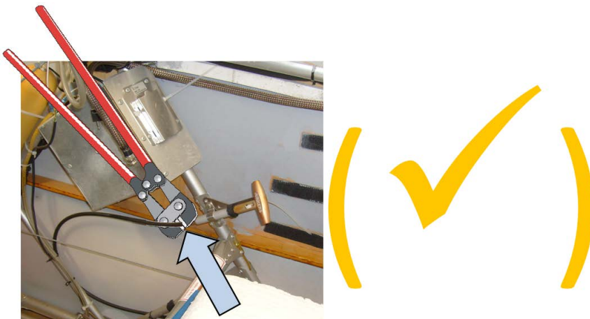
Abbildung 17: Falls es nicht möglich ist das Zugseil am Raketenmotor zu trennen, wird es hinter dem Auslösegriff getrennt
