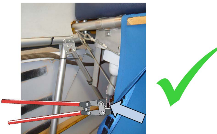
Abbildung 16: Das Durchtrennen des Zugseils der Auslöseeinrichtung am Raketenmotor im eingebauten Zustand
