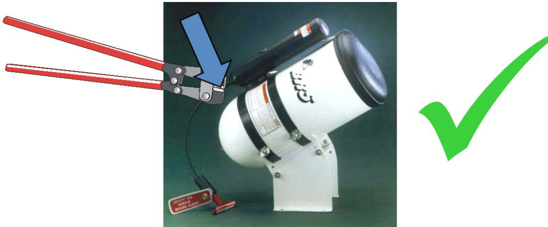
Abbildung 15: Beste Möglichkeit zur Sicherung des Raketenmotors – Das Durchtrennen des Zugseils der Auslöseeinrichtung am Raketenmotor
