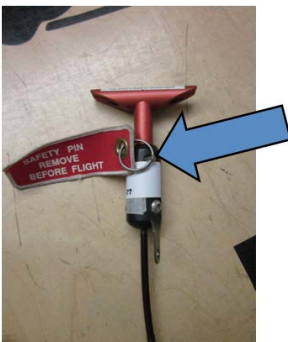
Abbildung 9: Sicherung der Auslöseeinrichtung mit einem Sicherungsstift
