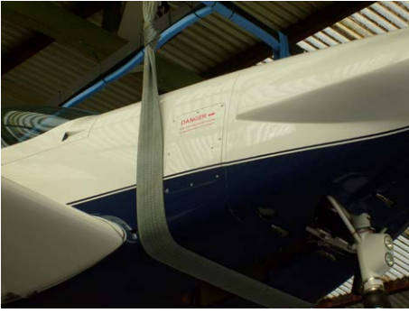
Abbildung 7: Ausstoßöffnung seitlich an der Flugzeugnase, Ausstoßrichtung zur Seite hin
