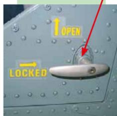
Die Cockpittüre rechts und links lassen sich durch Drehen des Türgriffes in die OPEN-Position öffnen.
