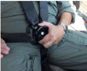
Die Gurte der Crew werden durch eine Drehung des Zentralschlösses geöffnet.
