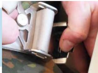
Die Gurte der Passagiere werden durch Anheben des Öffnungsschlösses geöffnet.
