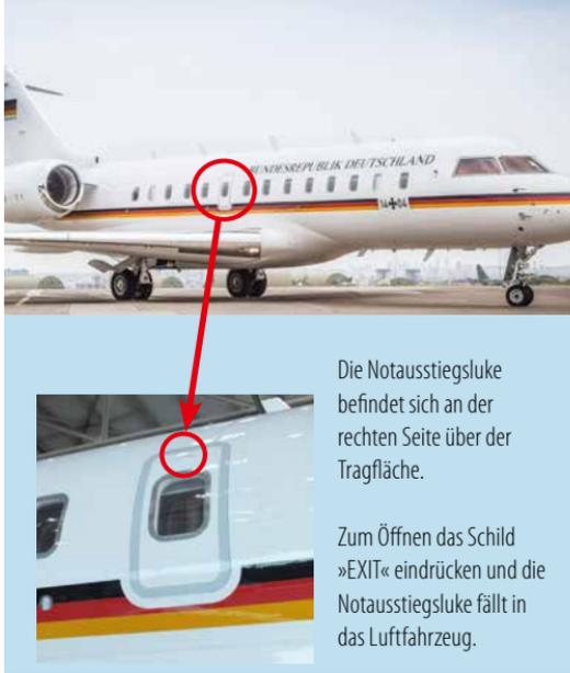
Die Notausstiegsluke befindet sich an der rechten Seite über der Tragfläche.
