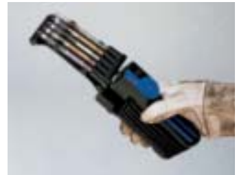
Messung mit dem Simultantest-Set
