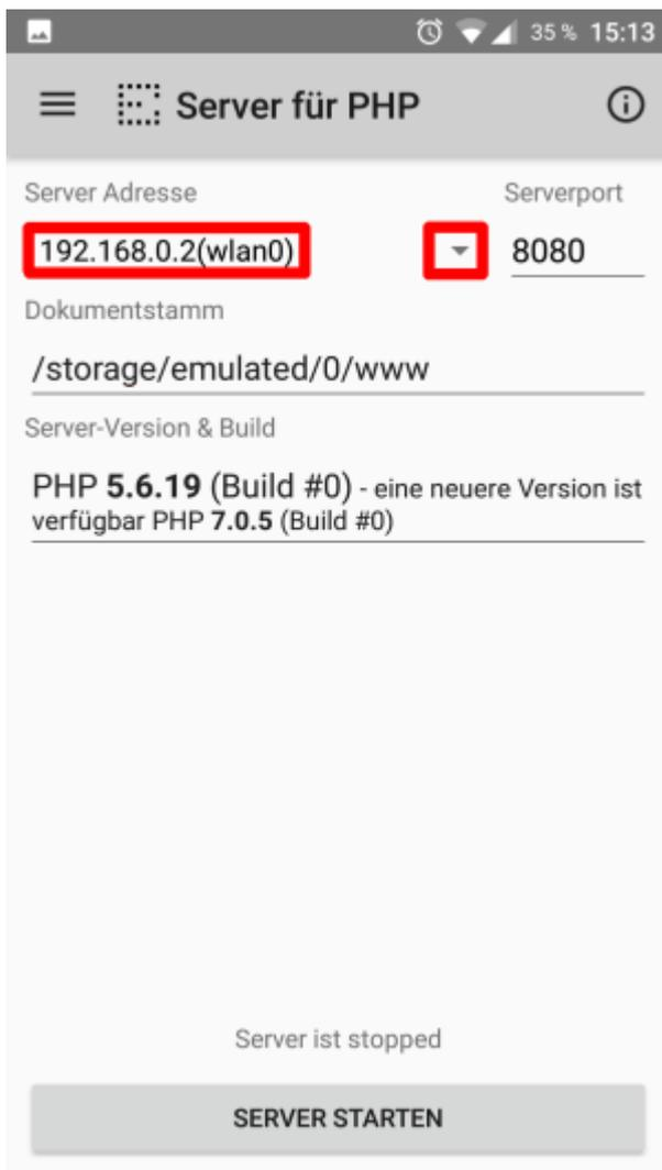
Oben links sehen Sie die IP-Adresse und die Schnittstelle, unter der der Server derzeit erreichbar ist. In der Konfiguration im Bild ist das die WLAN-Verbindung (was nach der Installation wohl standardmäßig eingestellt wird). Dies ist aber aus zwei Gründen ungünstig:
