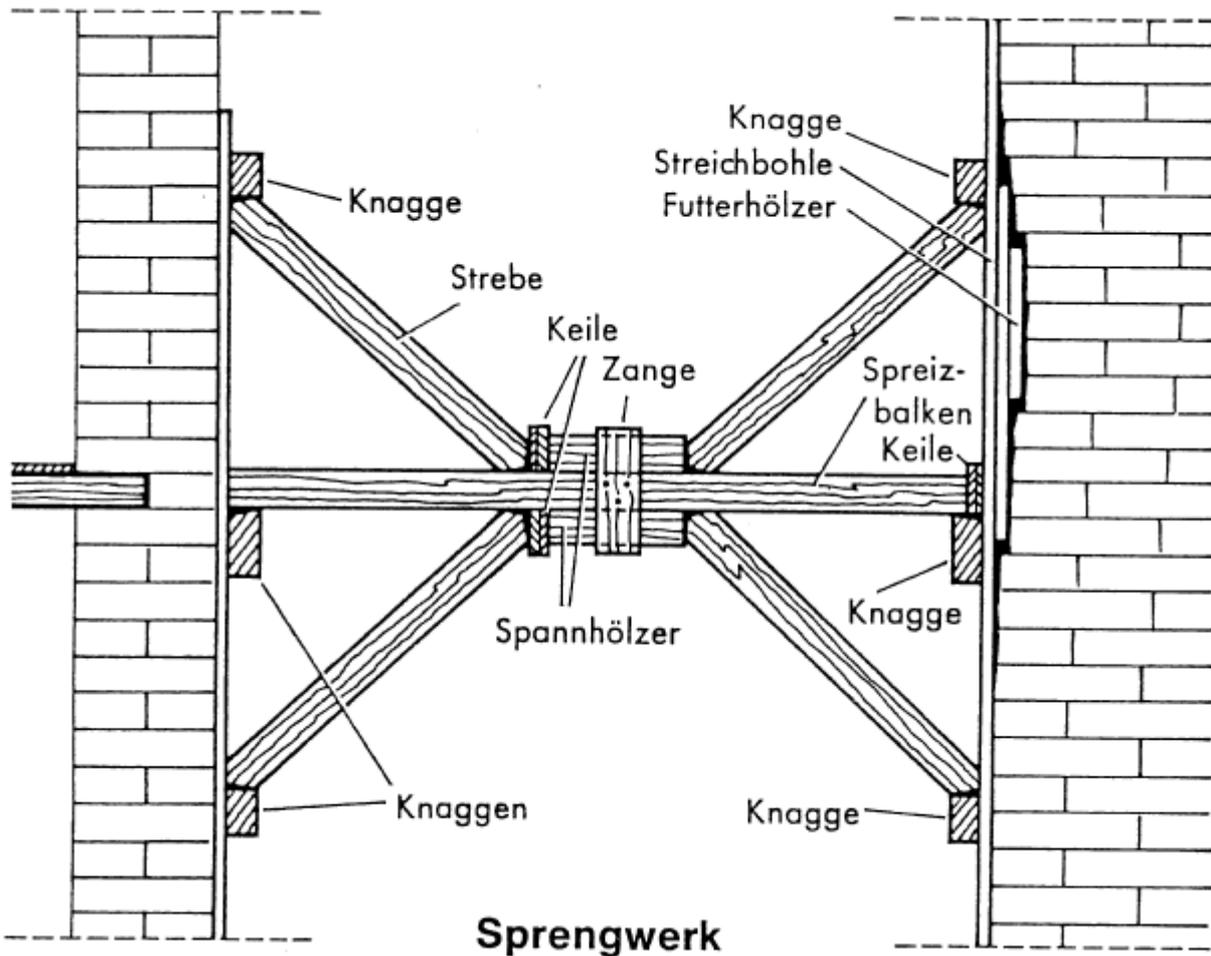
Das Sprengwerk dient der Aufnahme waagrechter und im geringen Umfang auch diagonaler Kräfte.
