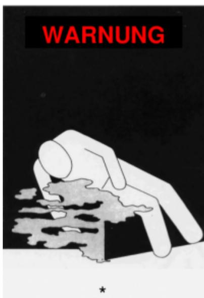
Fahrzeuge und Container, die gefährliche Güter zur Kühlung oder Konditionierung enthalten, müssen an jedem Zugang an einer für Personen, welche das Fahrzeug oder Container öffnen oder betreten, leicht einsehbaren Stelle mit diesem Warnkennzeichen versehen sein.
