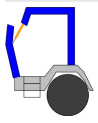
• Der erste Rettungszylinder kann dann entfernt werden und behindert die weiteren Rettungsarbeiten nicht.
