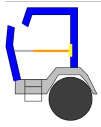
• Front mit Rettungszylinder wegdrücken, an der Schlossseite Schwelleraufsatz verwenden
