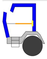
• Front mit Rettungszylinder wegdrücken, an der Schlossseite Schwelleraufsatz verwenden
