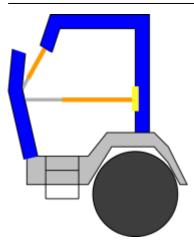
• Zweiten Rettungszylinder an der Position einsetzen an der sich ehemals die A-Säule befand.
