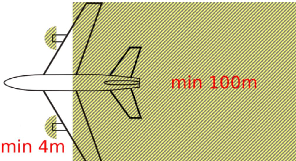
Bei **noch laufenden Triebwerken** muss in jedem Fall Abstand zum Triebwerk gehalten werden; kommt eine Person in den Gefahrenbereich vor der Einlassöffnung des Triebwerks kann diese komplett eingesogen und zerstückelt werden. Hinter den Triebwerken bzw. dem kompletten Flugzeug ist ein ausreichender Abstand zu halten, da selbst Fahrzeuge ansonsten einfach fortgeblasen werden können.
