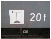
Alle Reisezugwagen, Triebfahrzeuge und viele Güterwagen haben Feststellbremsen. Diese sind mit der auf dem Bild gezeigten Anschrift gekennzeichnet.
