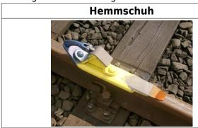
Zum Anhalten und Festsetzen von Schienenfahrzeugen. Hemmschuhe werden nur auf die Schiene gelegt, nicht befestigt.
