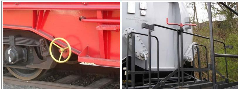
Güterwagen können über bodenbedienbare Bremsen oder über Spindelbremsen verfügen.
