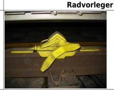
Radvorleger sind ausschließlich zur Sicherung stehender Fahrzeuge vorgesehen. Diese werden auf der Schiene befestigt.
