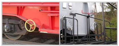
Güterwagen können über bodenbedienbare Bremsen oder über Spindelbremsen verfügen.
