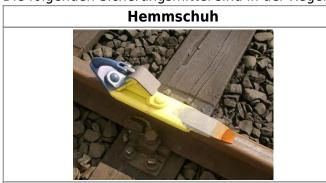
Zum Anhalten und Festsetzen von Schienenfahrzeugen. Hemmschuhe werden nur auf die Schiene gelegt, nicht befestigt.
