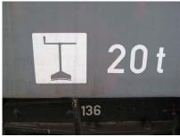
Alle Reisezugwagen, Triebfahrzeuge und viele Güterwagen haben Feststellbremsen. Diese sind mit der auf dem Bild gezeigten Anschrift gekennzeichnet.
