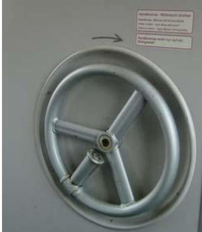
Feststellbremsen von Triebfahrzeugen und Reisezugwagen werden durch ein Feststellbremsrad betätigt. Dieses gibt es nur auf einer Seite in Lok bzw. Wagen.
