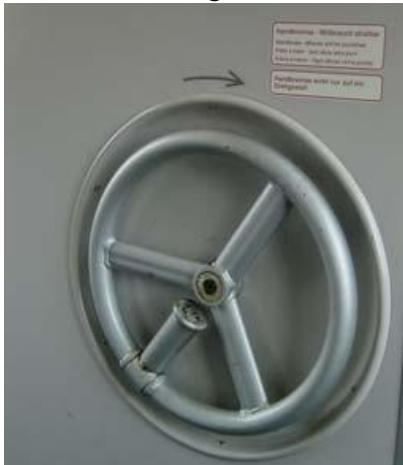
Feststellbremsen von Triebfahrzeuge und Reisezugwagen werden durch ein Feststellbremsrad betätigt. Dieses gibt es nur auf einer Seite in Lok bzw. Wagen.
