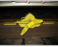
Radvorleger sind ausschließlich zur Sicherung stehender Fahrzeuge vorgesehen. Diese werden auf der Schiene befestigt.
