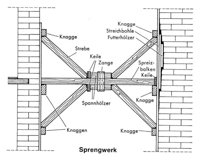
Das Sprengwerk dient der Aufnahme waagrechter und im geringen Umfang auch diagonaler Kräfte. **Durchführung:**
