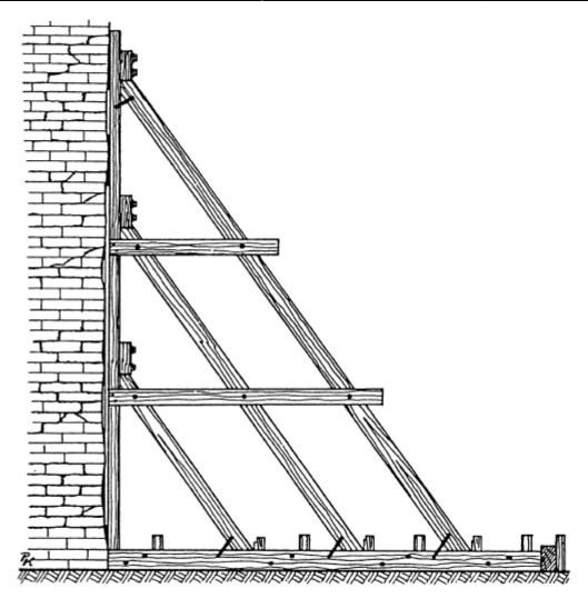
Stützbock mit dreifacher Strebstütze auf Bohlentreiblade
