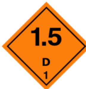
Bei der Gefahrgutkennzeichnung von Explosivstoffen muss auf dem Gefahrzettel (Placard) neben der Unterklasse auch die so genannte Verträglichkeitsgruppe angegeben werden. Diese gibt einen weiteren Aufschluss über die Eigenschaften des Explosivstoffs und dem Transporteur Hinweise welche verschiedenen Explosivstoffe zusammen transportiert werden dürfen.
