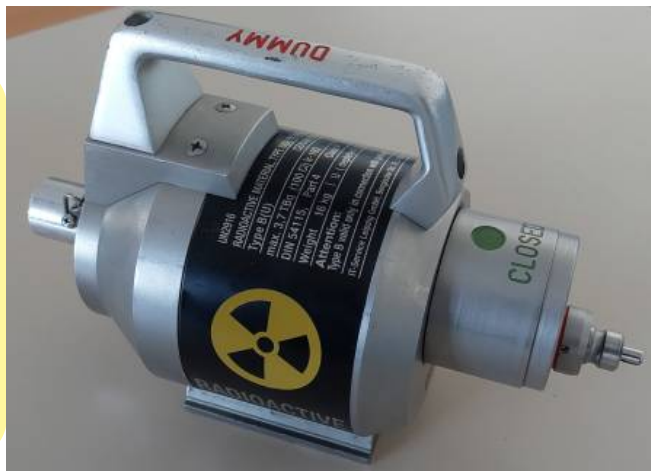
Gamma-Arbeitsgerät ohne Strahlerführung und Fernbedienung (Handkurbel)
