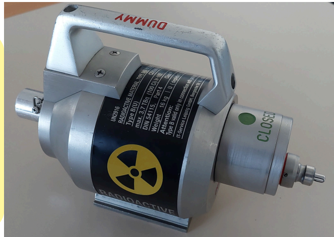
Gamma-Arbeitsgerät ohne Strahlerführung und Fernbedienung (Handkurbel)
