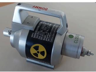
Gamma-Arbeitsgerät ohne Strahlerführung und Fernbedienung (Handkurbel)
