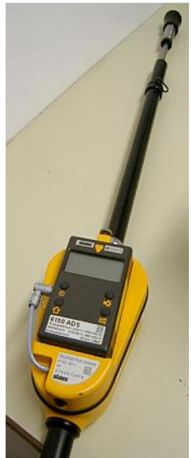
Der Einsatzbereich des Dosisleistungsmessgeräts ist die kontinuierliche Dosisleistungsmessung. Meist wird nur Gamma-Strahlung gemessen, beim Einsatz spezieller Sonden ist aber auch der Nachweis von Beta-Strahlung möglich. Die Messeinheiten sind in der Regel Sv/h, mSv/h,  $\mu$ Sv/h und nSv/h.
