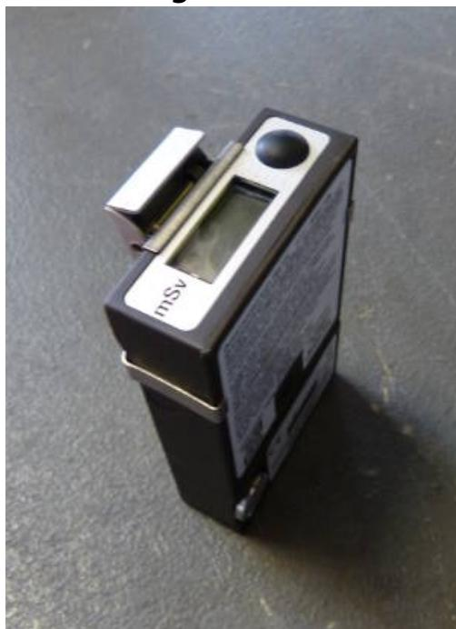
Das Dosiswarngerät alarmiert beim Erreichen der jeweils eingestellten Alarmschwelle. Diese sind, entsprechend der [Dosisrichtwerte](#), 15 mSv, 100 mSv, 250 mSv und 1 mSv. Es kann nur Gamma-Strahlung registrieren.
