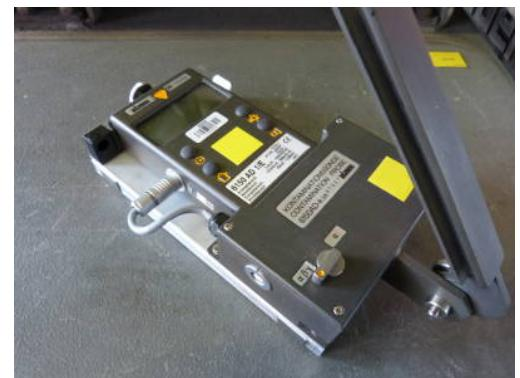
Das Kontaminationsnachweisgerät wird genutzt, um die Oberflächenkontamination von Personen und Objekten durchzuführen. Außerdem dient es der Messung der Nullrate. Die Messeinheit ist [Impulse](#) pro Sekunde (Imp/s bzw. IPS) oder gleichbedeutend 1/s.
