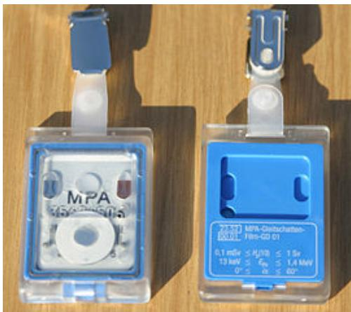
Das Gleitschatten-Filmdosimeter ist von jeder Person zu tragen, die im Strahlenschutzeinsatz tätig wird. Es wird nur Gamma-Strahlung registriert. Es ist der einzige amtliche Nachweis über die aufgenommene Dosis.
