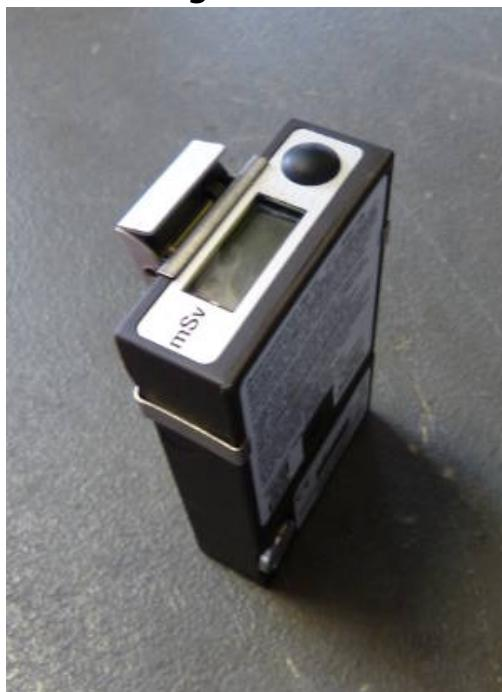
Das Dosiswarngerät alarmiert beim Erreichen der jeweils eingestellten Alarmschwelle. Diese sind, entsprechend der [Referenzwerte \(vormals Dosisrichtwerte\)](#),  $20 \text{ mSv}$ ,  $100 \text{ mSv}$ ,  $250 \text{ mSv}$  und  $1 \text{ mSv}$ . Es kann nur Gamma-Strahlung registrieren.
