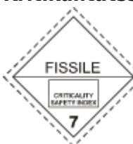
Bei Stoffen mit nebenstehender Kennzeichnung handelt es sich um spaltbares Material. Auf der Kennzeichnung ist die Kritikalitätssicherheitskennzahl CSI (Criticality Safety Index) angegeben, die besagt wie weit der transportierte Stoff von der kritischen Masse entfernt ist. Der maximale CSI beträgt 50; je kleiner der CSI desto ungefährlicher.
