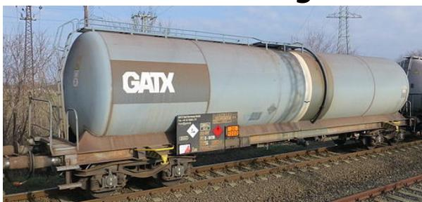
Mineralölkesselwagen mit einer senkrechten weißen Bauchbinde besitzen ein Zwangsbelüftungssystem. Sie werden in der Regel von oben befüllt und unten entleert. Die Zwangsbelüftung sorgt dabei dafür, dass mit dem Öffnen des Entleerungsventils gleichzeitig ein Ventil oben am Tank geöffnet wird welches den entstehenden Unterdruck ausgleicht.
