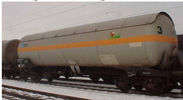
Kesselwagen für verflüssigte, tiefgekühlt verflüssigte oder gelöste Gase sind mit einem durchgehenden, etwa 30 cm breiten orangefarbenen Streifen gekennzeichnet, der den Tank in etwa halber Höhe umschließt.
