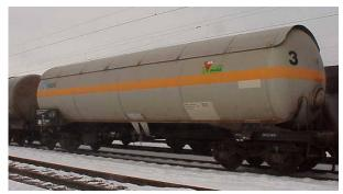
Kesselwagen für verflüssigte, tiefgekühlt verflüssigte oder gelöste Gase sind mit einem durchgehenden, etwa 30 cm breiten orangefarbenen Streifen gekennzeichnet, der den Tank in etwa halber Höhe umschließt.
