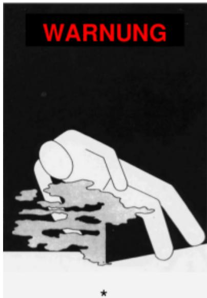
Fahrzeuge und Container, die gefährliche Güter zur Kühlung oder Konditionierung enthalten, müssen an jedem Zugang an einer für Personen, welche das Fahrzeug oder Container öffnen oder betreten, leicht einsehbaren Stelle mit diesem Warnkennzeichen versehen sein.
