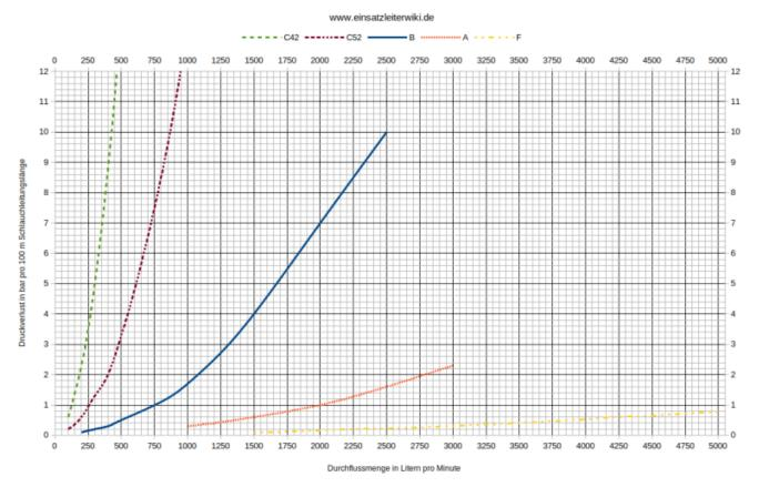
Druckverluste bei verschiedenen Schlauchgrößen (klicken um die Grafik in voller Größe zu öffnen) **Schlauchhaspeln**
