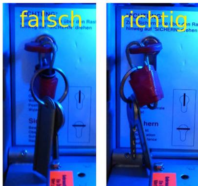
Um die Auslösung eines Sabotage-Alarms zu verhindern, sollte bei Schlüsseln die sich waagrecht in der *Sichern*-Position befinden folgendes beachtet werden:
