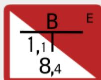
**Löschwasserbrunnen mit Tiefpumpe (Elektropumpe [E] oder**
