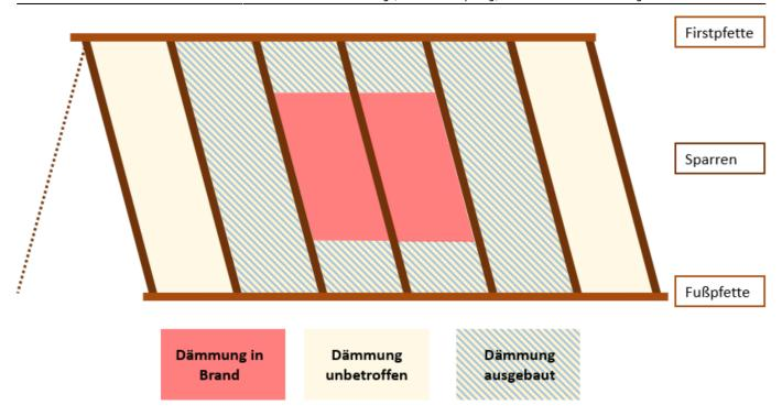
Abbildung: Schneisenbildung und Teilausbau der Dämmung um den vom Brand betroffenen Bereich (Branddirektion München)
