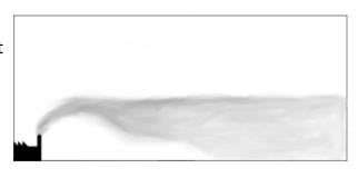
Bleibt diese Lage über längere Zeit erhalten, kann es zu einer drastischen Anreicherung der Schadstoffe kommen. Ist die Durchmischungszone zum Beispiel durch eine Tal- oder gar Kessellage recht klein, so ist auch eine Auflösung der Inversion durch Wind stark eingeschränkt, was die Anreicherung der Abgase entsprechend begünstigt. Eine solche Tallage und ebenso ein hoher Schadstoffausstoß ist gerade für Ballungsräume charakteristisch.
