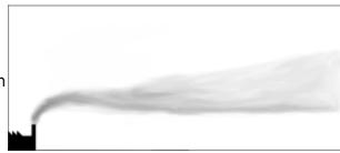
Schadstoffe maximal bis zur Obergrenze der Inversion absinken. Dort zeigt sich dann auch meist eine höhere Abgaskonzentration. Nach oben hin wird die vertikale Ausbreitung jedoch nicht behindert. **Für die Luftverschmutzung ist dies eine sehr wünschenswerte Situation**: Die Rauchgasfahne verdünnt sich, erreicht jedoch nicht die Erdoberfläche. Auftreten v.a. am frühen Abend bei wolkenlosem Himmel, in den meisten Fällen von kürzerer Dauer.
