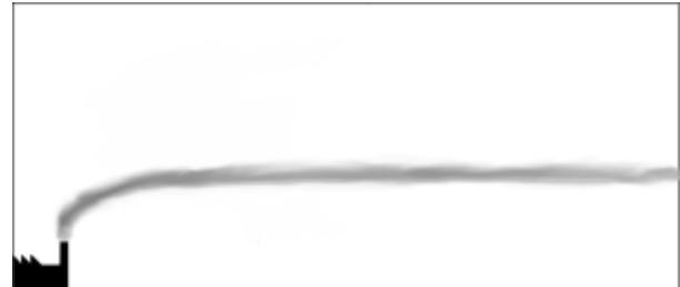
Inversionswetterlage. Der Rauch steigt bis zur Höhe auf, bei der sich die Inversion befindet. Die Rauchfahne wird kaum verdünnt. Die hohen Abgaskonzentrationen bleiben auch noch in erheblicher Entfernung zum Schornstein erhalten. Bodennah ist die Belastung hier gering, hoch ist sie allerdings bei Auftreten von Geländeerhöhungen in der Ausbreitungs-Richtung. Auftreten v.a. nachts und bei Tiefdruck, wobei es sich häufig um die Vorstufe zu Fumigation (siehe unten) handelt.
