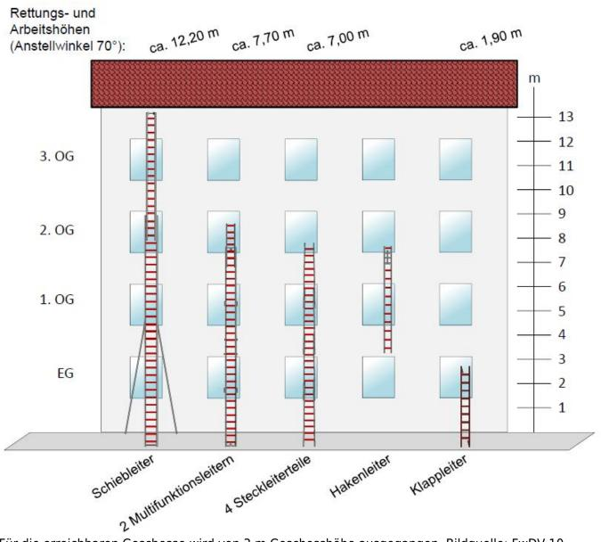
Für die erreichbaren Geschosse wird von 3 m Geschosshöhe ausgegangen. Bildquelle: FwDV 10 **Einsatzgrundsätze (nach FwDV 10)**
