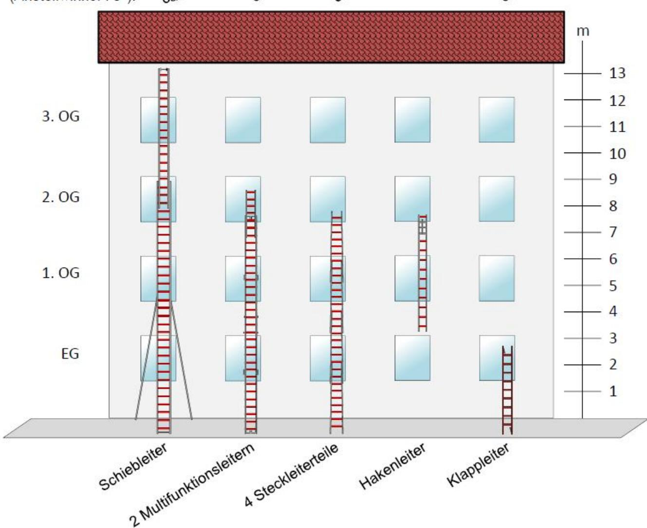
Für die erreichbaren Geschosse wird von 3 m Geschosshöhe ausgegangen. Bildquelle: FwDV 10
