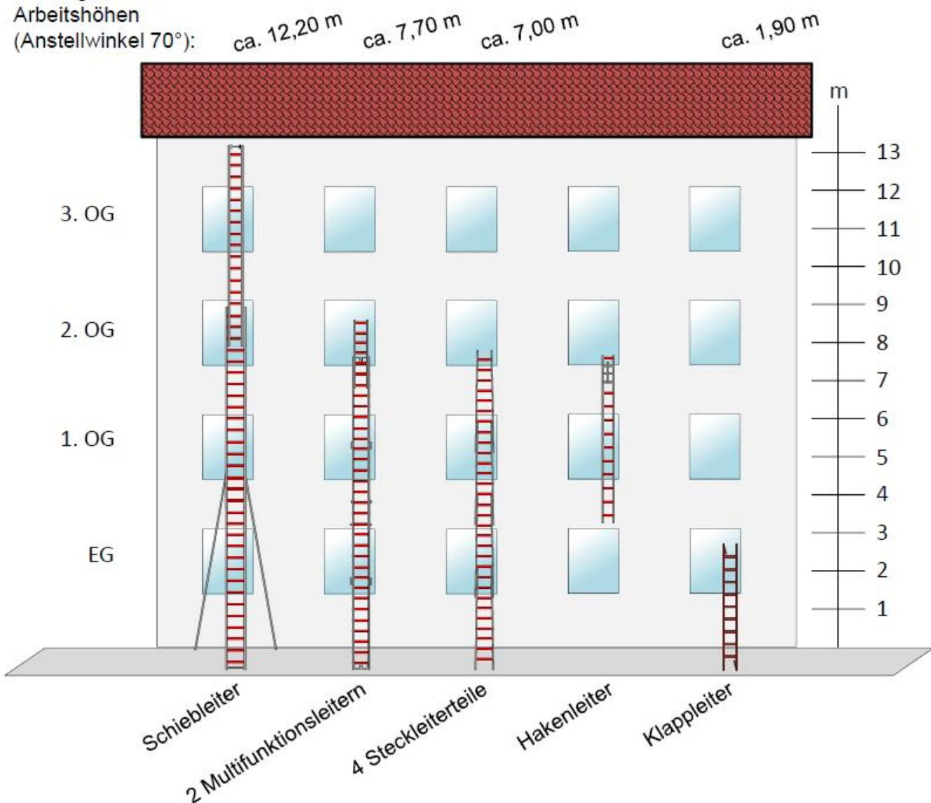
Für die erreichbaren Geschosse wird von 3 m Geschossgröße ausgegangen. Bildquelle: FwDV 10
