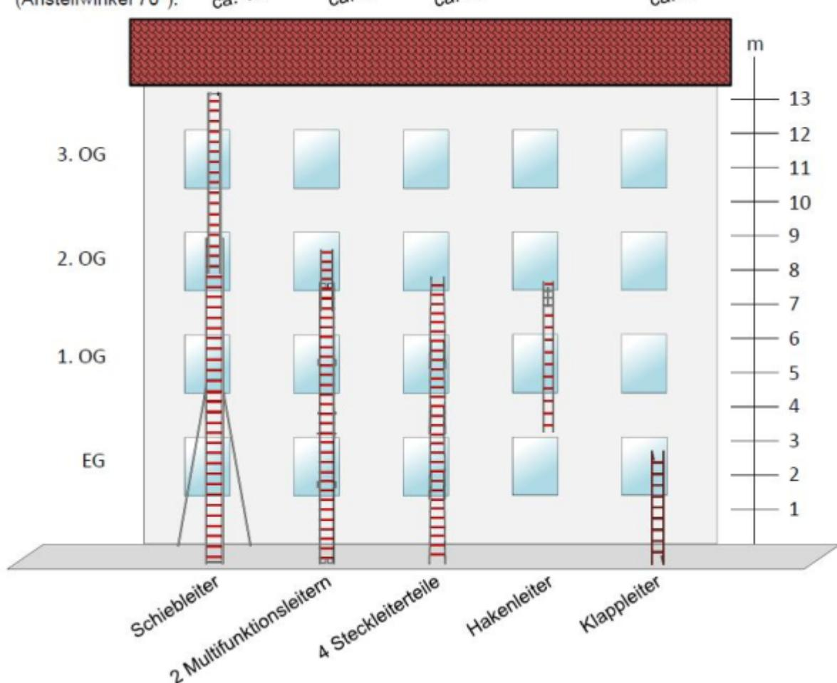
Für die erreichbaren Geschosse wird von 3 m Geschossgröße ausgegangen. Bildquelle: FwDV 10
