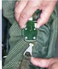
Das Lösen der Armrückholbänder erfolgt durch Lösen der einzelnen Verbindung.
