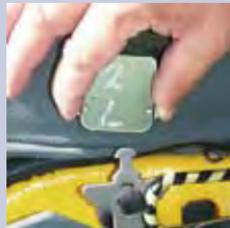
Die Verbindung zum Rettungsboot am Sitz lösen, indem der Verschluss mit zwei Finger gleichzeitig betätigt wird. Die lose Verbindungsleine in die Weste stecken.
