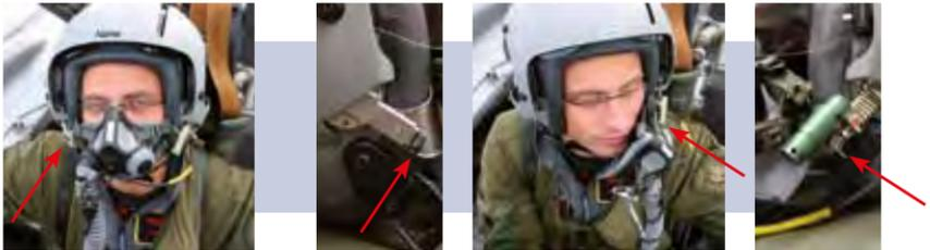
3| Die Atemmaske wird durch Ziehen an dem kleinen Winkel der Entriegelungseinheit rechts und links vom Helm gelöst.
