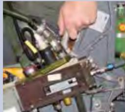
Die Beatmungsanschlüsse der Besatzung am Schleudersitz und das Lösen der Beirückholbänder werden durch einen Hebel gelöst (PEC-Teil).
