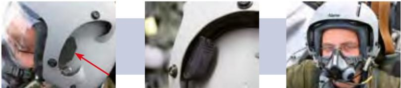
2| Verriegelungsknopf für das Klarsichtvisier mit beiden seitlichen Verriegelungsknöpfen gleichzeitig nach hinten schieben (Verkantungsgefahr).
