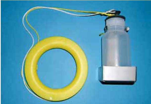
Abb. 11: Wasserprobenahmegerät für die Entnahme von Wasser aus der Tiefe
