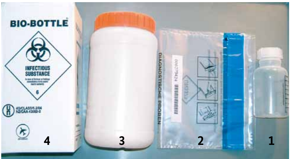
Abb. 18: Beispiel für eine Verpackung nach P 620 (ADR): Probengefäß (1) = Primärgefäß, PE-Beutel (2), Sekundärverpackung (3) und Außenverpackung (4) (Kartonage)
