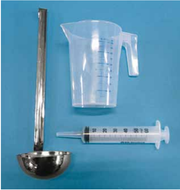
Abb. 21: Schöpfkelle, Messbecher und Spritze für die Entnahme von Flüssigproben
