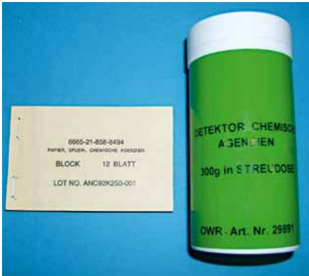
Abb. 16: Kampfstoffspürpapier (links) und Dose mit Spürpulver (rechts)
